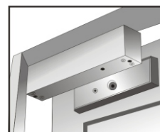
吸板安装槽架效果
